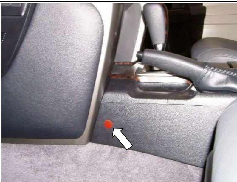
Отметить местоположение считывающего устройства красной меткой на внешней стороне консоли.
